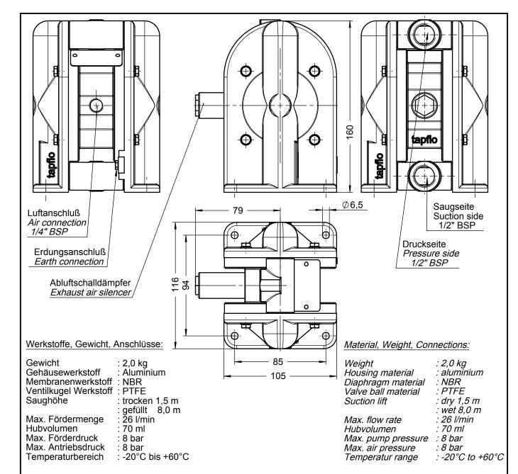
Sämtliche Informationen hinsichtlich der Installation, des Betriebes, der Wartung, sowie der technischen Daten und des Ex-Schutz sind dem beigefügten Handbuch des Pumpen-Herstellers und der DOK-527 der Fa. FMC zu entnehmen.
