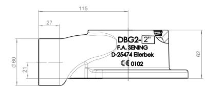
Wird die Verwendung einer Dauerbrandsicherung vorgeschrieben so ist der DBG2 zu verwenden. Die Dauerbrandsicherung stellt einen ausreichenden Wetterschutz dar und hat keinen signifikanten Einfluss auf das Belüftungsvermögen.
