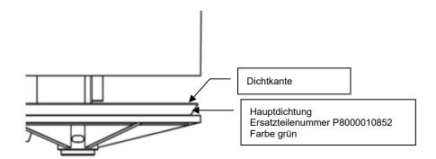
Nach dem Tausch der Hauptdichtung ist das Öffnen und dichte Schließen des Ventils zu prüfen.
