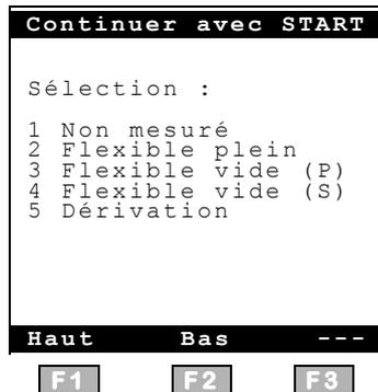
Un fonction du type de commande utilisé, la sélection de flexible peut être affichée sur le MultiFlow avec les chemins de flexible disponibles. Avec la commande entièrement électronique, la « sélection de flexible » s'affiche sur le MultiFlow avec le dernier chemin de flexible sélectionné. Le cas échéant, le chemin de flexible doit être sélectionné sur le MultiFlow à l'aide des touches <F1> ou <F2>, puis confirmé avec <Enter>.
