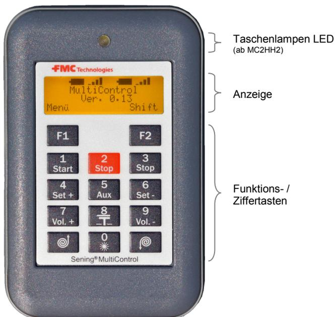
Abb. 1: Funktionstasten des Handbedienteils
