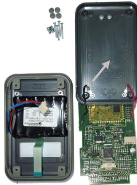
**8** Den neuen Akku mit den mitgelieferten Klebestreifen wieder einkleben. Das Akkukabel muss zu der ausgefrästen Seite liegen.
