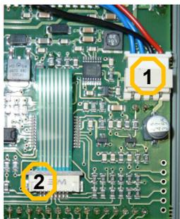
**4** 2.) Das Flachbandkabel lösen, indem die dunkle Verriegelung nach oben geschoben wird. Das Kabel abziehen.
