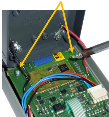
**11** Funktionstest nach dem Zusammenbau des MC2HH(2). Im Display erscheinen Batteriesymbol und „S E N I N G“.
