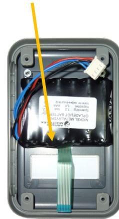
**9** Nun das MC2HH(2) wieder in umgekehrter Reihenfolge zusammenbauen. Dabei Vorsicht beim Einfädeln des Flachbandkabels: es darf nicht geknickt werden!
