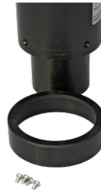
**4** Unterteil mit leichter Drehung vorsichtig aus dem Gehäuse ziehen.
