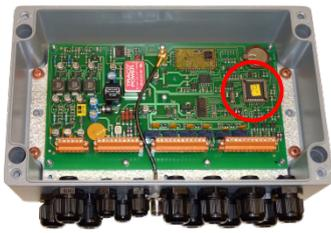
3. Tauschen Sie die den Microcontroller gegen eine MCU mit der Download-Software aus!
