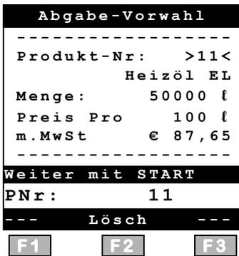
Wenn die Abgabe unterbrochen wurde, kann am MultiFlow oder über das Handbedienteil eine neue Vorwahlmenge eingegeben werden. Der Vorwahl-Bildschirm wird angezeigt, sobald bei einer unterbrochenen Abgabe durch Betätigen der Taste <F1> am MultiFlow die Eingabe einer Zusatzmenge ermöglicht wird.
