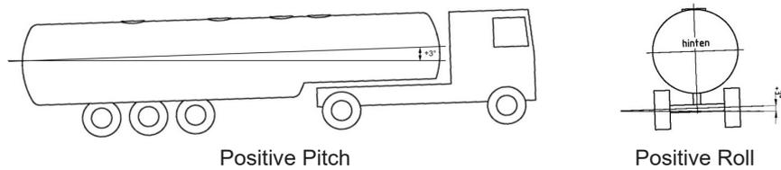
**Figure 14:** Inclination
