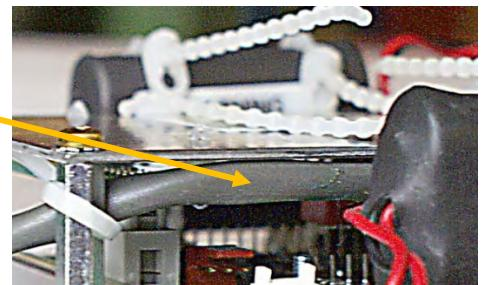
☞ Ziehen Sie nun das Verbindungskabel zwischen Batterie und Elektronik von der Elektronik ab.
