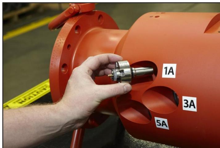
5. Separe o transdutor da montagem do transdutor.
