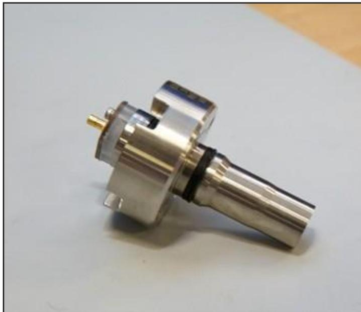
7. Instale o novo transdutor no furo do transdutor do corpo do medidor e alinhe os orifícios de passagem na montagem do transdutor com os furos roscados na caixa.
