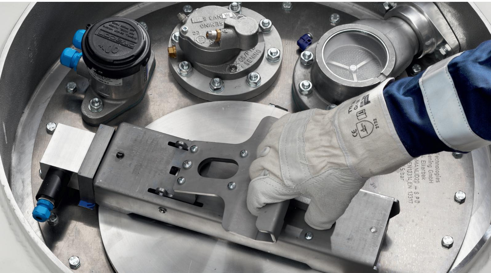
Dauerbrandlüfter/Kippventil-Kombination DGB2-2/DO702-F, Pneumatische Überfüllsicherung HANV in unterschiedlichen Längen
